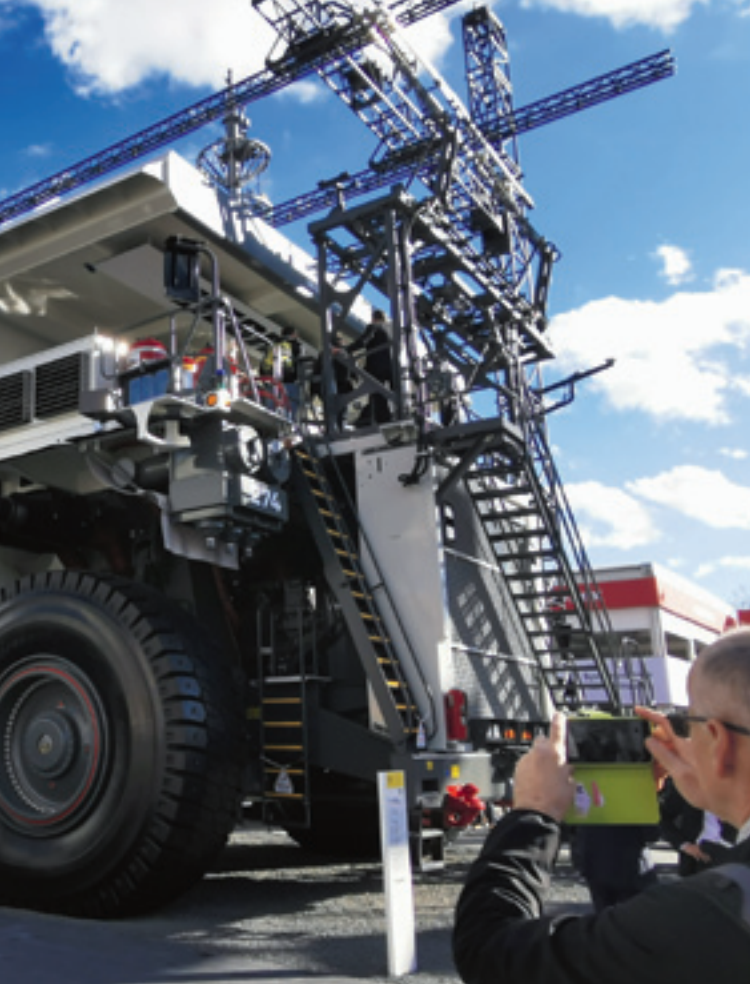
Hingucker vor dem Liebherr-Stand: Der Riesenmuldenkipper T724 mit Stromabnehmern, die ihm helfen, mit Stromunterstützung für die Elektromotoren an den einzelnen Rädern leichter sein geladenes Material aus der Erzgrube nach oben zur Weiterverarbeitung zu bringen. Alle Bilder: Sanders
